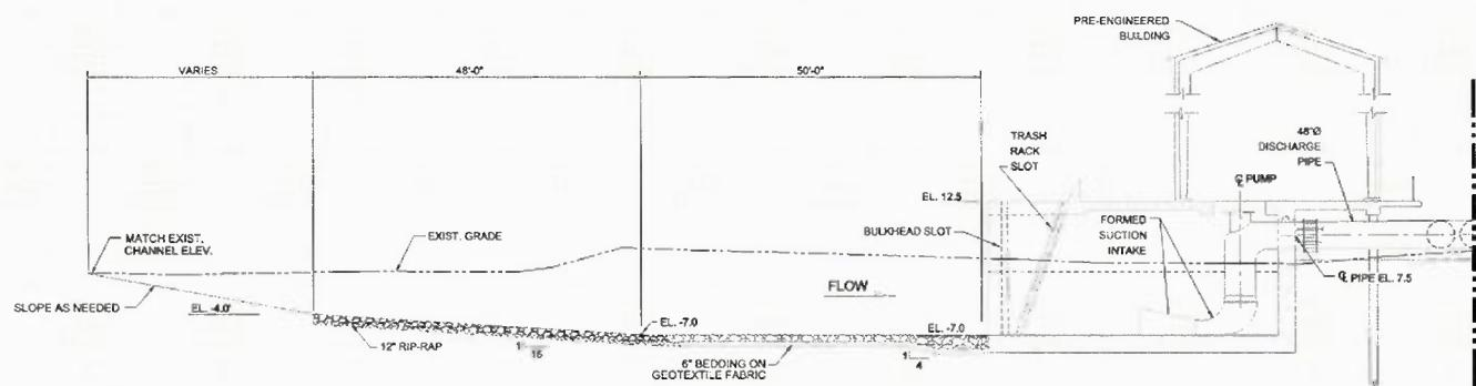
TYPICAL CROSS SECTION OF PUMP STATION - LOOKING WEST
